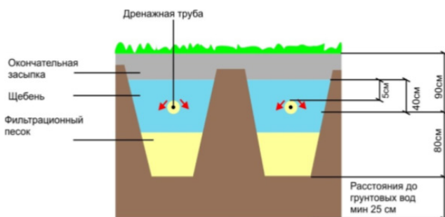
Рис. 6. Поперечное сечение поля фильтрации
